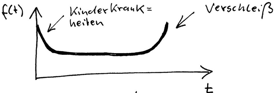
Am Beginn und am Ende des Lebens einer Komponente kann die Anzahl der Ausfälle pro Zeit erhöht sein. ↑ Testreihe einer
