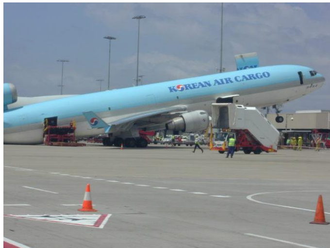
Bild 6.12 Schwerpunkt hinter dem Hauptfahrwerk [ www.airliners.net ]
