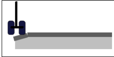
Bild 2.1 Versagen eines starren Belages (Trahmer 2004)
