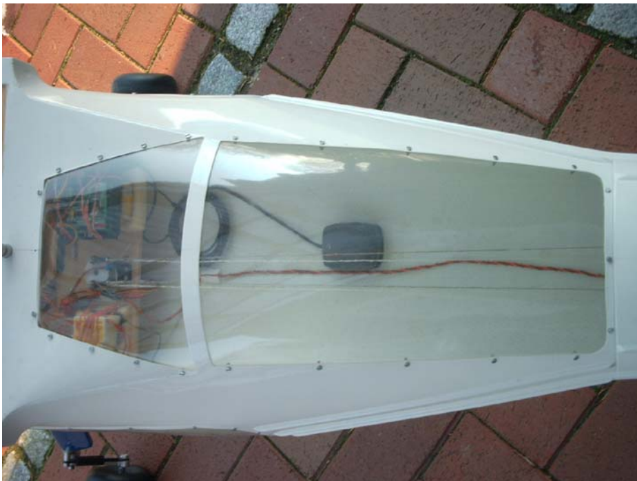
Abbildung 4.11 Positionierung des GPS-Empfängers
