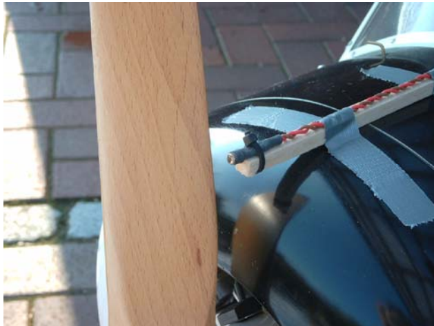
Abbildung 4.1 Positionierung des Drehzahlsensors
