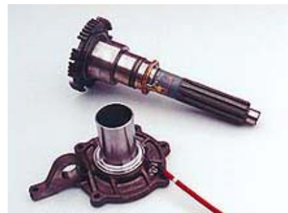
Abb 3.3: Drehmomentmessung an Getriebewellen
