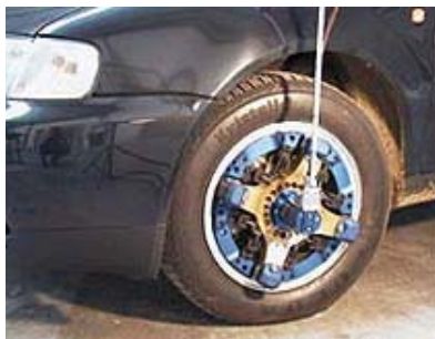
Abb 3.1: Messrad mit telemetrischer Signalübertragung
