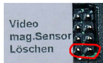
Abb 5.7: Jumperstellung zum Löschen des Speichers
