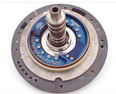
Abb 3.2: Temperaturmessung im Automatik-Getriebe
