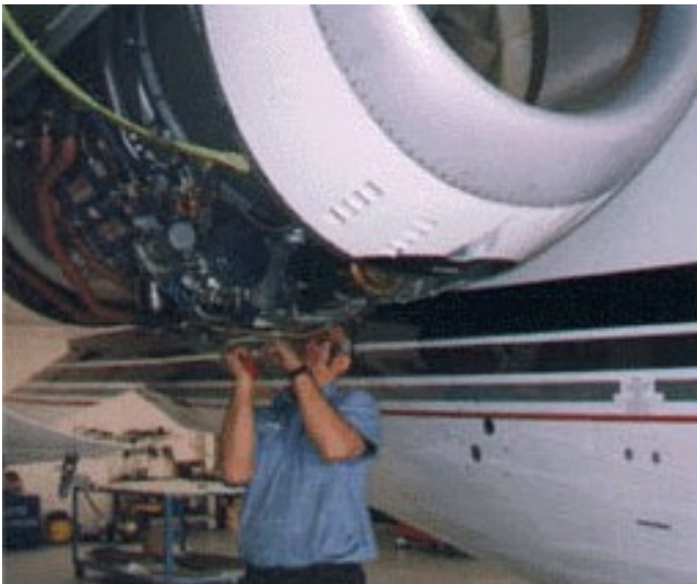
Bild 5.28 Wartungsarbeiten bei einer heckseitigen Triebwerksintegration (Quelle unbekannt)
