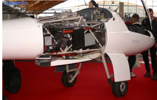
Bild 3.2 Stemme Motorsegler mit Triebwerksanordnung hin dem Piloten ( www.airliners.net )
