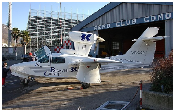
Bild 3.4 Lake LA-250 mit Motoranordnung oberhalb des Rumpfes ( Aeroclub di Como 2004)
