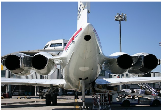
Bild 3.20 Ilyushin IL-62 mit ausgefahrener Heckstütze gegen Kippen ( unbekannte Quelle )
