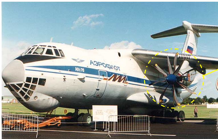
Bild 2.7 Propfan einem Ilyushin-76 Transporters ( www.airliners.net )
