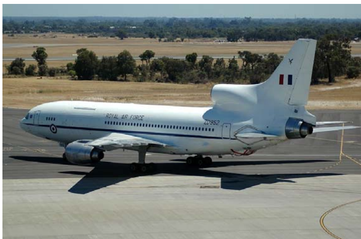
Bild 3.24 Lockheed L1011 TriStar1 mit einem Triebwerk in der Rumpfstruktur ( www.airliners.net )
