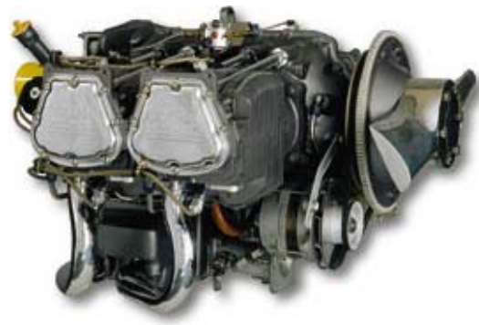
Bild 2.4 Lycoming O-360, typischer Flugmotor in 4 Zylinder Boxerbauweise ( Textron Lycoming 2004 )
