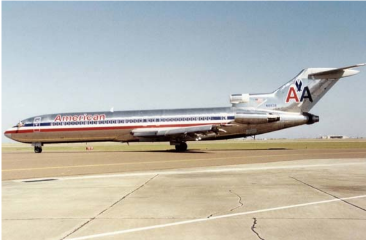
Bild 3.26 Boeing B-727 mit drei Hecktriebwerken ( www.airliners.net )
