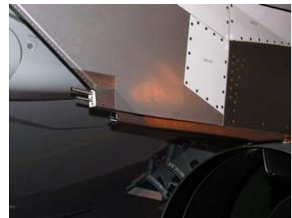
Bild 5.28 Drainmast am Pylon (Endesfelder 2004)
