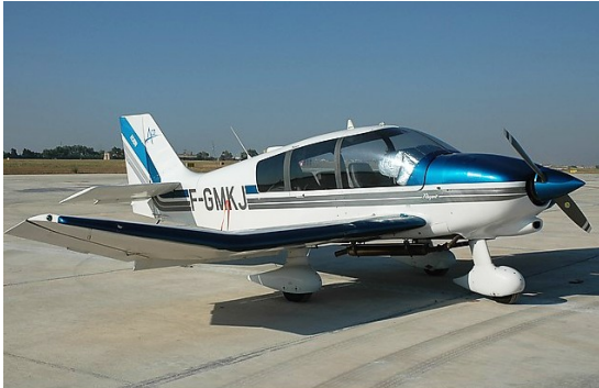
Bild 3.1 Robin DR400 mit Motoranordnung in der Flugzeugnase ( www.airliners.net )
