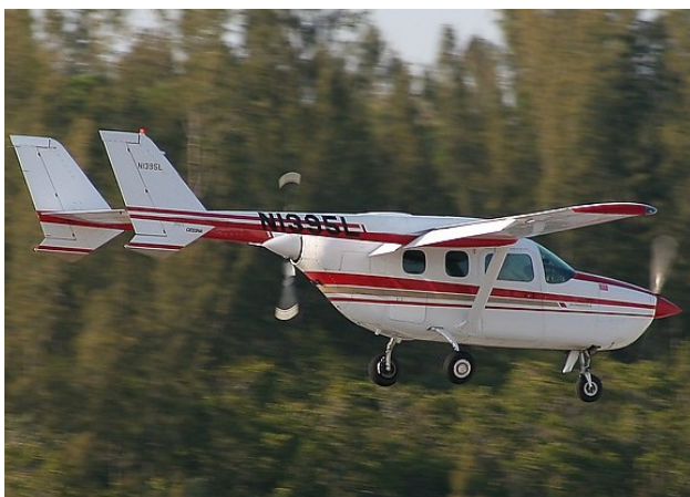
Bild 8.2 Cessna T337H Skymaster II mit 2 Antrieben auf der Mittellinie (www.airliners.com)
