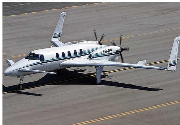
Bild 3.6 Beech Starship I mit Druckpropellern ( www.airliners.net )
