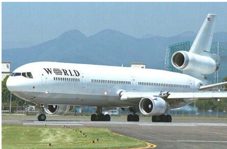
Bild 3.25 McDonnell Douglas MD11 mit einem Triebwerk in der Seitenleitwerksstruktur ( Quelle unbekannt )
