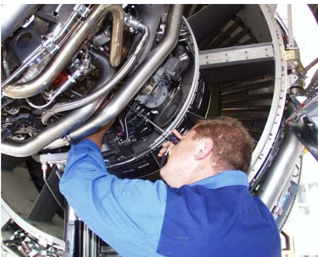
Bild 5.29 Borescope Inspektion nach Fremdkörperschaden im Verdichter (Endesfelder 2004)
