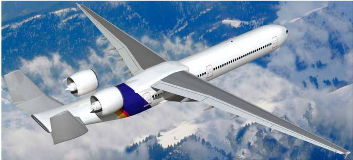
Bild 9.10 Ökoflugzeug mit ummantelten Propfantriebwerken (Schmitt 2005)
