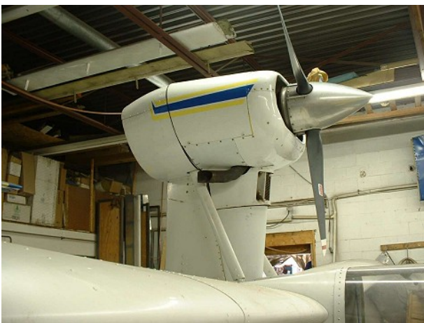
Bild 5.4 Pylon angeordnet über dem Rumpf (Teal 2004)
