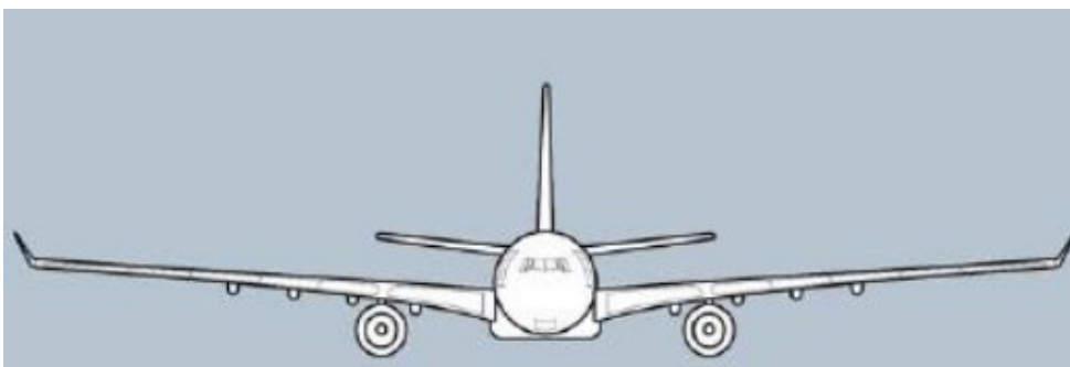
Bild 2.4 Typische Zweistrahlerkonfiguration (Airbus A330) ( Kozulovic 2016 )
