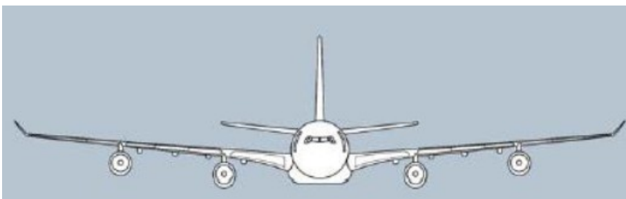
Bild 2.6 Typische Vierstrahlerkonfiguration (Airbus A340) (Kozulovic 2016)
