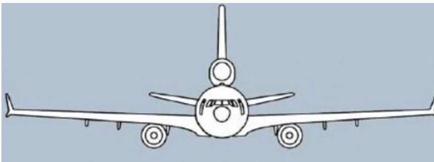
Bild 2.5 Typische Dreistrahlerkonfiguration (MD-11) (Kozulovic 2016)
