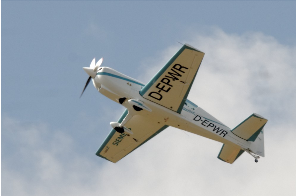
Extra 330LE mit elektrischem 260 kW Motor von Siemens. Max. Flugdauer: 20 Minuten. (Marie-Lan Nguyen, CC BY)
